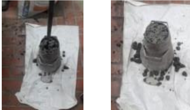
Ilustración 35 Última capa Cono de Abrams
