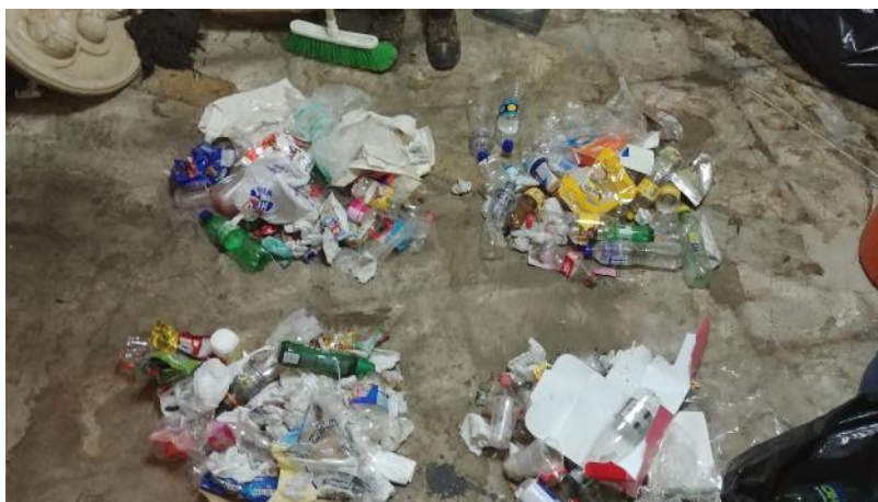
Ilustración 14. Método de cuarteo
