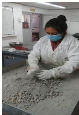
Ilustración 18. Mezcla del concreto
