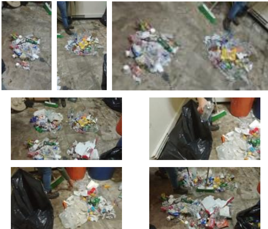
Ilustración 31. Método de Cuarteo
