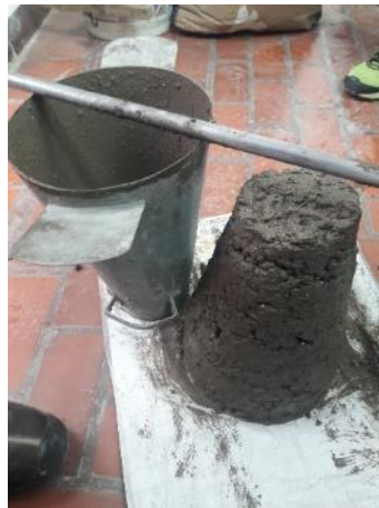
Ilustración 25. Cono de Abrams
