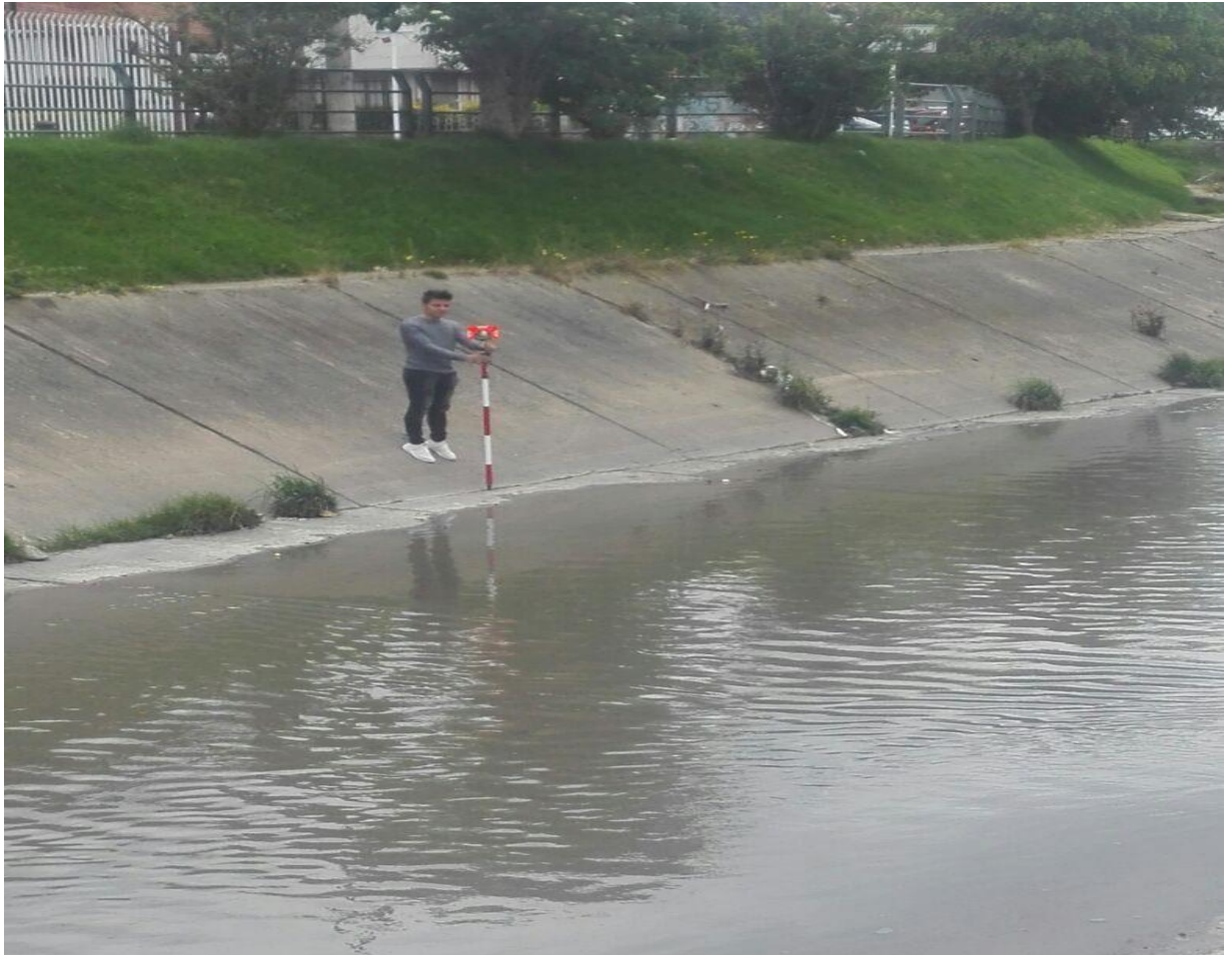
Figura 22. Toma de puntos para la sección 11.
