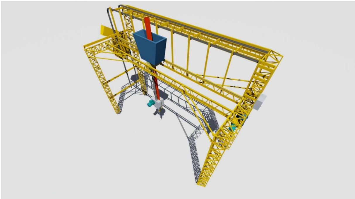
Figura 1- 33. Impresora de coordenadas rectangulares con estructura aporricada. Vista lateral
