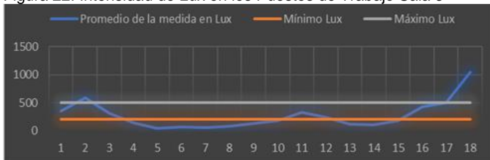
Figura 22. Intensidad de Lux en los Puestos de Trabajo Sala 3
