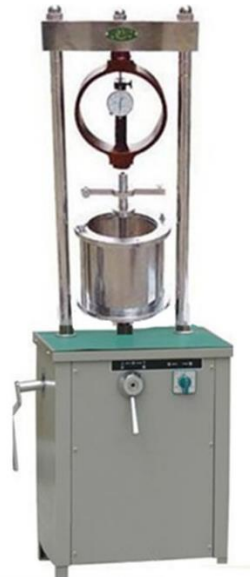
Figura 19. Equipos compresión (Zealchon)
