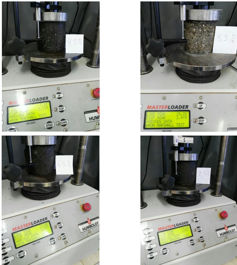
Figura 23. Ensayo de probetas a inmersión – compresión variando % de asfalto (Elaboración propia)
