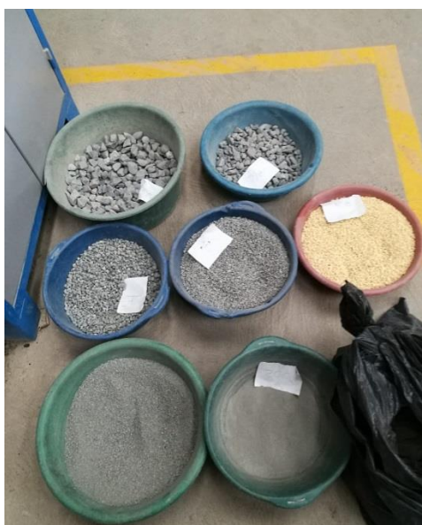
Figura 16. Tamizado del material para ajuste a curva patrón (Elaboración propia)
