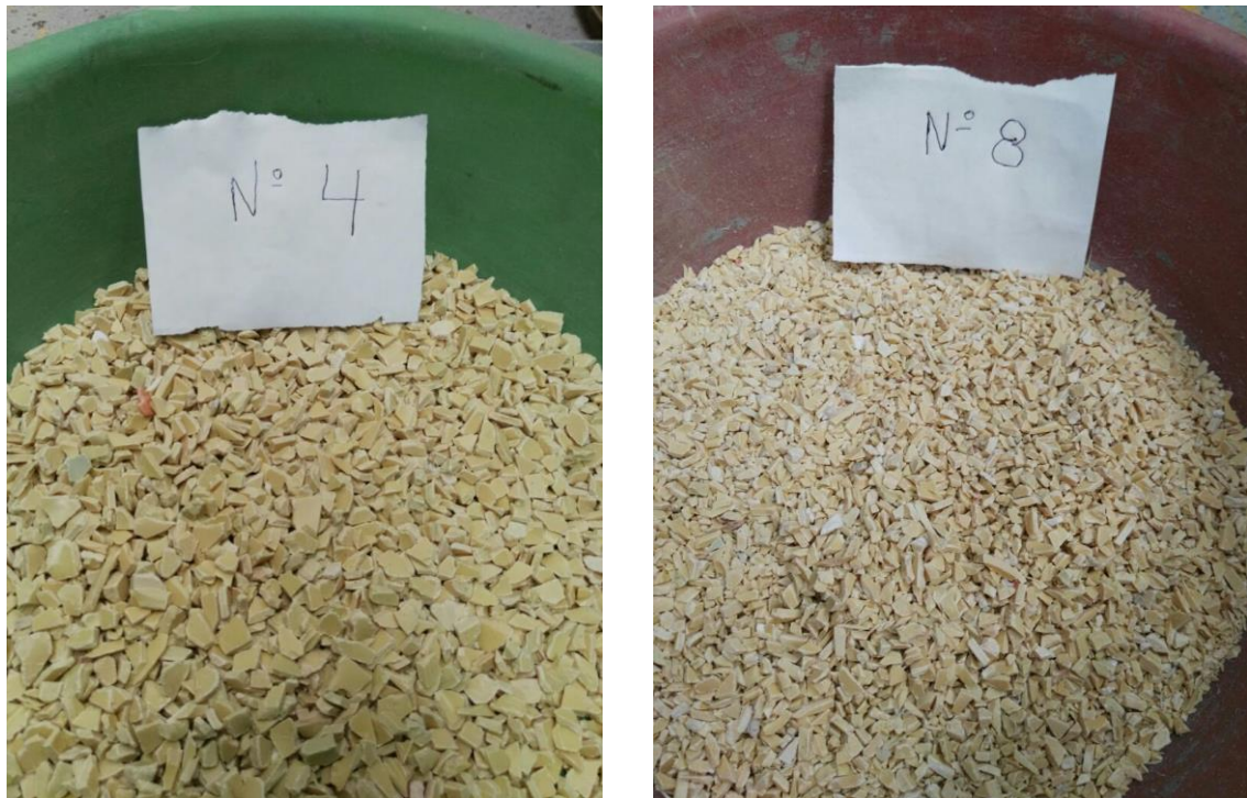
Figura 20. Material obtenido a partir de la trituración de tubos de PVC (Elaboración propia)
