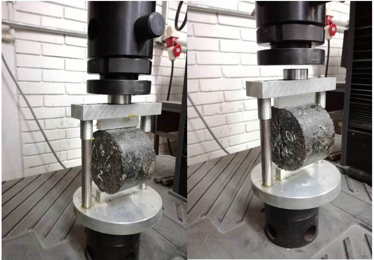
Figura 30. Proceso de falla a tracción indirecta (Elaboración propia)
