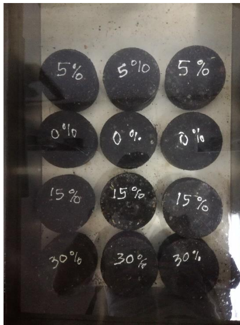
Figura 32. Inmersión de cuerpos de prueba para ensayo a tracción indirecta húmeda (Elaboración propia)
