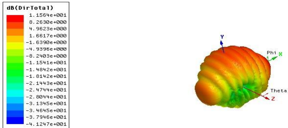
Figura 82. Directividad antena Yagi optimizada.
