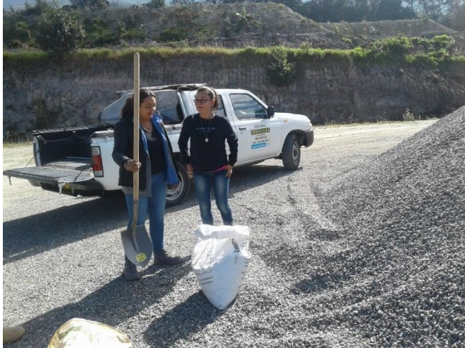
Foto No. 5: Grava de ½"
