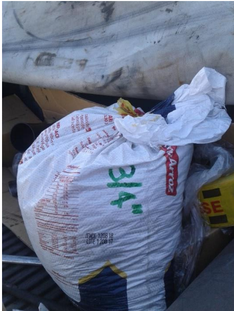
Foto No. 7: Grava de ¾" enlonada
