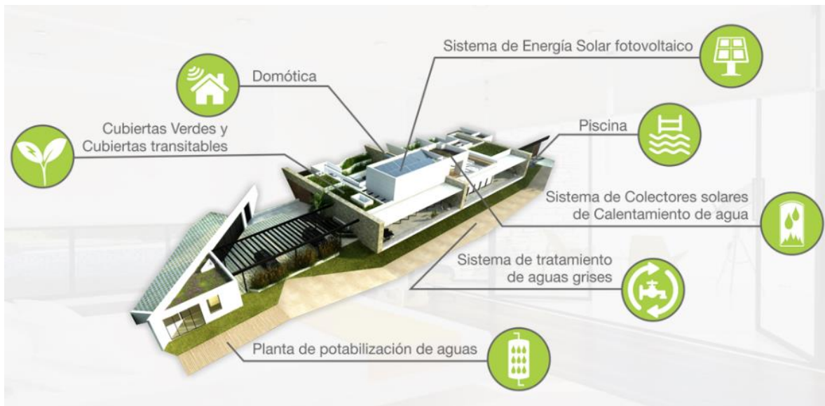
Ilustración 13. Sistemas implementados en la vivienda.
