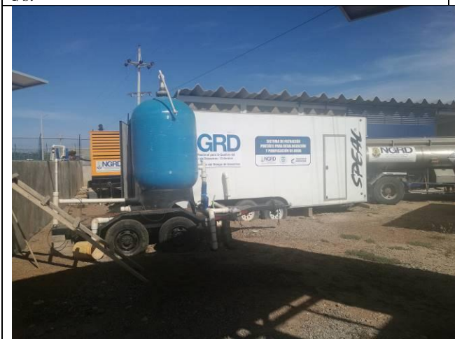
Foto 3: Planta de tratamiento por RO para atender pequeñas demandas de zona rural, alimentada eléctricamente con PGE móvil.
