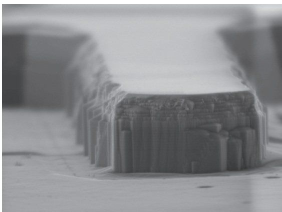
Abbildung 2.10.: Ausrichtungskreuz auf einer prozessierten Laserschicht nach dem Nassätzen, deren Maske schlecht gegenüber der kristallographischen Achse ausgerichtet war.
