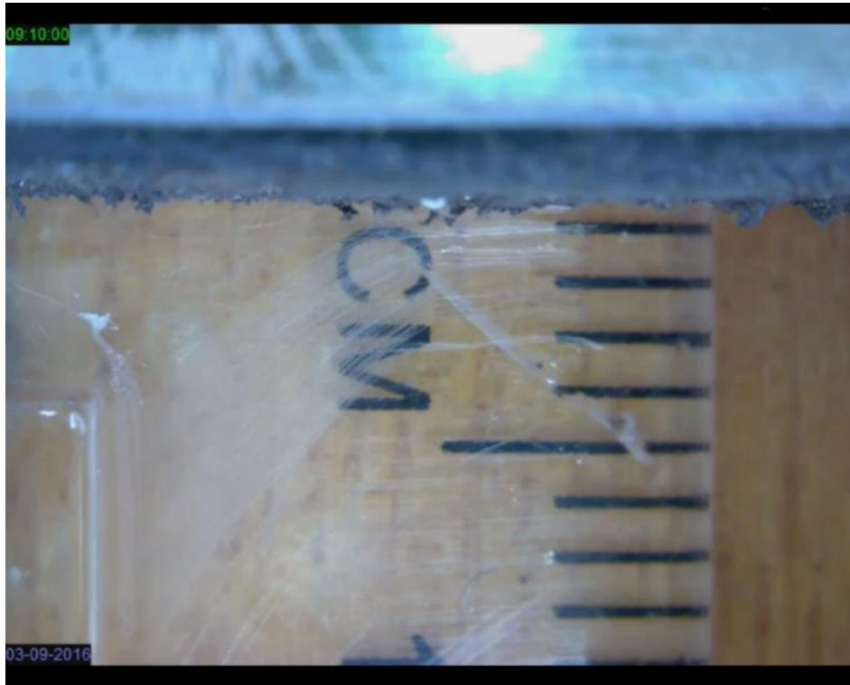
Figura 31 - Exemplo de uma amostra vídeo da expansão da placa com o microscópio digital.
