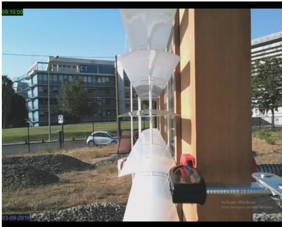
Figura 29 - Exemplo de uma amostra vídeo do movimento de inclinação das lâminas do estore.
