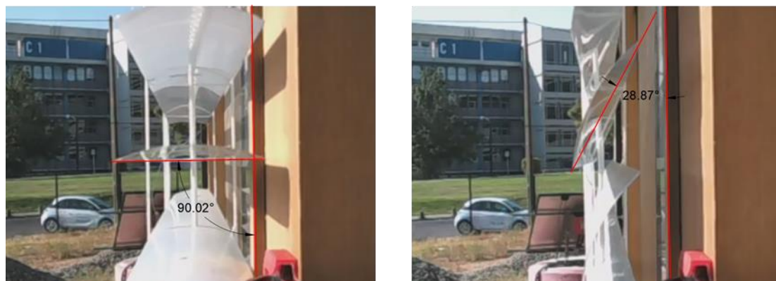
Figura 30 - Exemplo da medição do ângulo das lâminas. Imagem à esquerda – início do deslocamento. Imagem à direita – ângulo medido entre a lâmina e a Fachada Viva .
