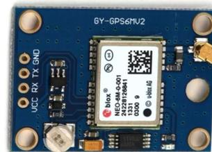
(d) Sensor GPS NEO 6-M [Arduino, 2018c]
