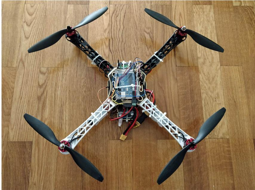
Figura 5.7: Hardware do Quadcopter preparado para voo
