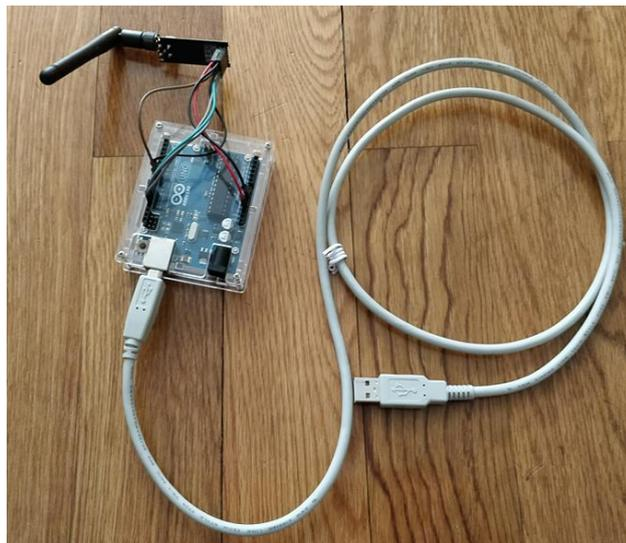
Figura 5.14: Hardware da estação de controlo terrestre
