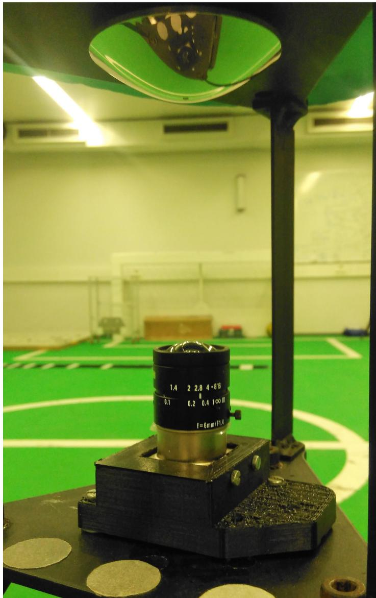
Figura 3.5: Conjunto câmara-espelho após o ajuste do alinhamento.
