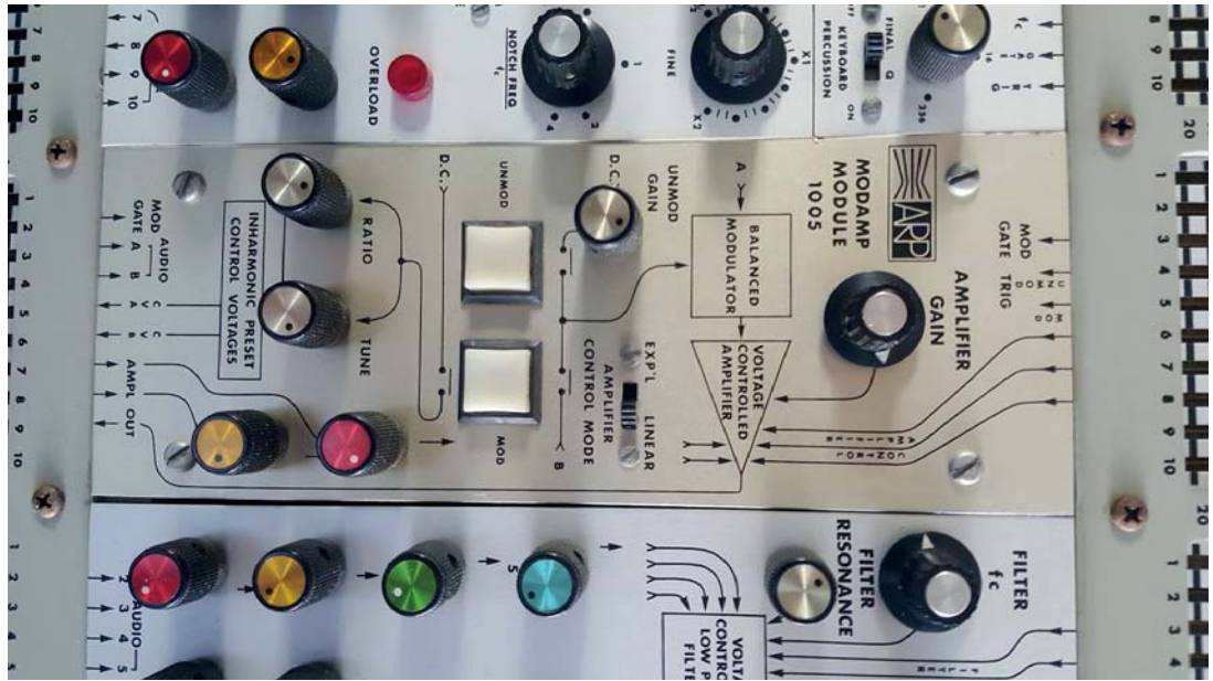
Abb. 15: Das Modamp-Modul 1005 und das Filteramp-Modul 1006 des Synthesizers ARP 2500
