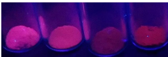
Abb. 68 Lumineszenz von YVO_4:Sm -NP v. l. n. r. pH = 7; 6; 5 und 4 ( \lambda_{ex} = 254 nm).
