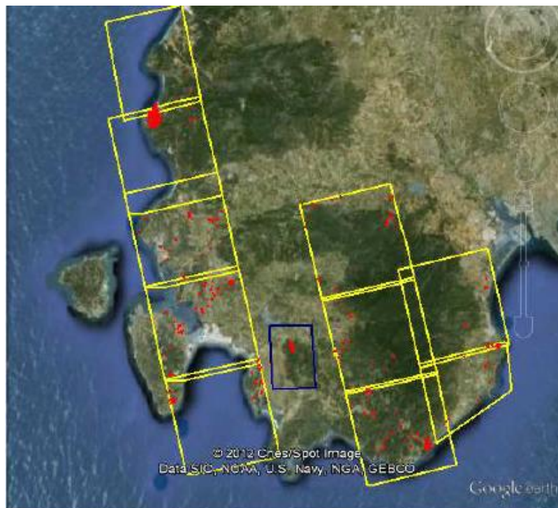
Figura 3.5: Esempio di APF ad altissima risoluzione per la regione Sardegna (2011): evidenziati in giallo le impronte al suolo dei dati Kompsat 2, in blu quelle del dato WorldView, in rosso le APF 1:2000.
