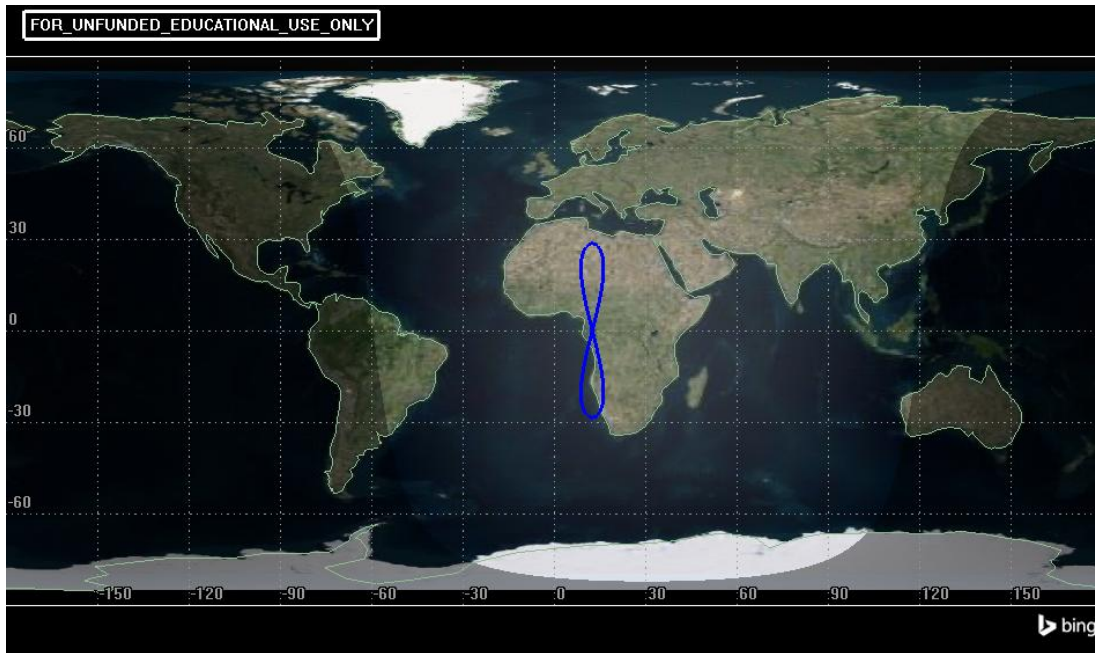
Figura 1.9: Traccia a terra di un'orbita geosincrona non-equatoriale ( i=28^\circ ).
