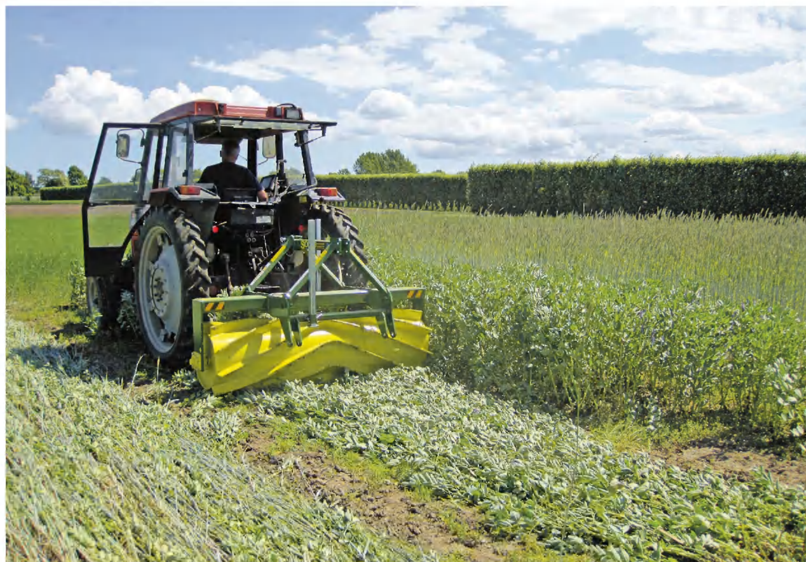
Nogle uger før udplantningen af hvidkål, har en såkaldt knivtromle lagt grøngødningen ned og knækket stænglerne. Det har gjort det muligt at så kålen direkte i grønafgrøden. Foto: Hanne Lakkenborg Kristensen, AU-FOOD.
