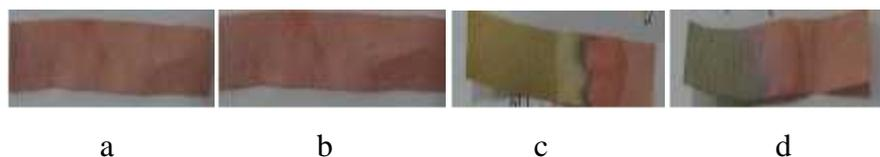
Gambar 3. Hasil perbandingan pengujian indikator asam basa lemah dari ekstrak daun *Rhoeo discolor* menggunakan pelarut etanol 96% + HCl 1% dengan: (a) larutan asam kuat (HCl), (b) larutan asam lemah (CH<sub>3</sub>COOH), (c) larutan basa kuat (NaOH), (d) larutan basa lemah (NH<sub>4</sub>OH)
