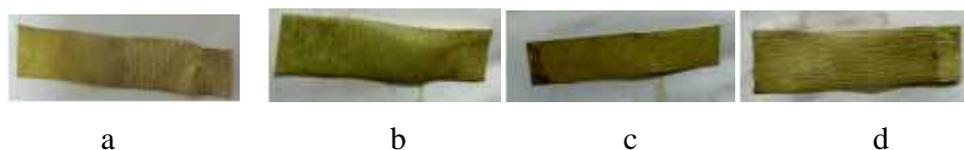
Gambar 3. Kertas saring dengan pelarut etanol 96% setelah dicelupkan dengan asam kuat (a), asam lemah (b), basa kuat (c), basa lemah (d)
