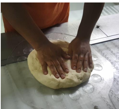
Figura 5. Postura tomada en la formación de masa previa a máquina divisora boleadora del método JSI
