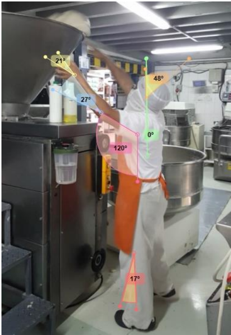
Figura 1. Colocación de masa en la máquina divisora con mediciones angulares del método REBA.
