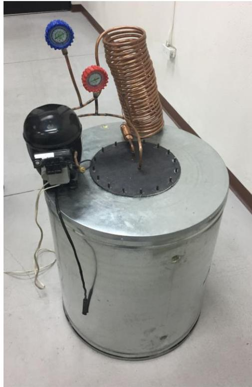
**Figura 11. Bomba de Calor Completa**
