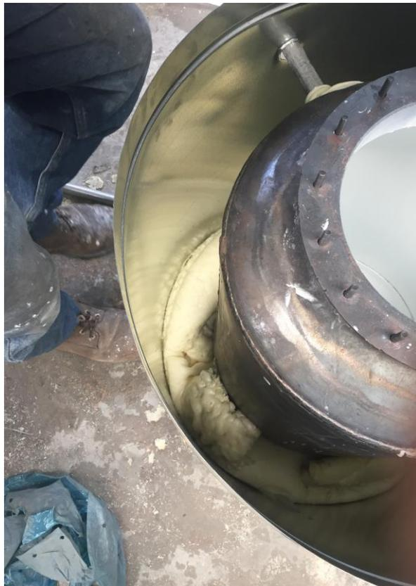
**Figura 10. Inyección del Aislante Térmico**
