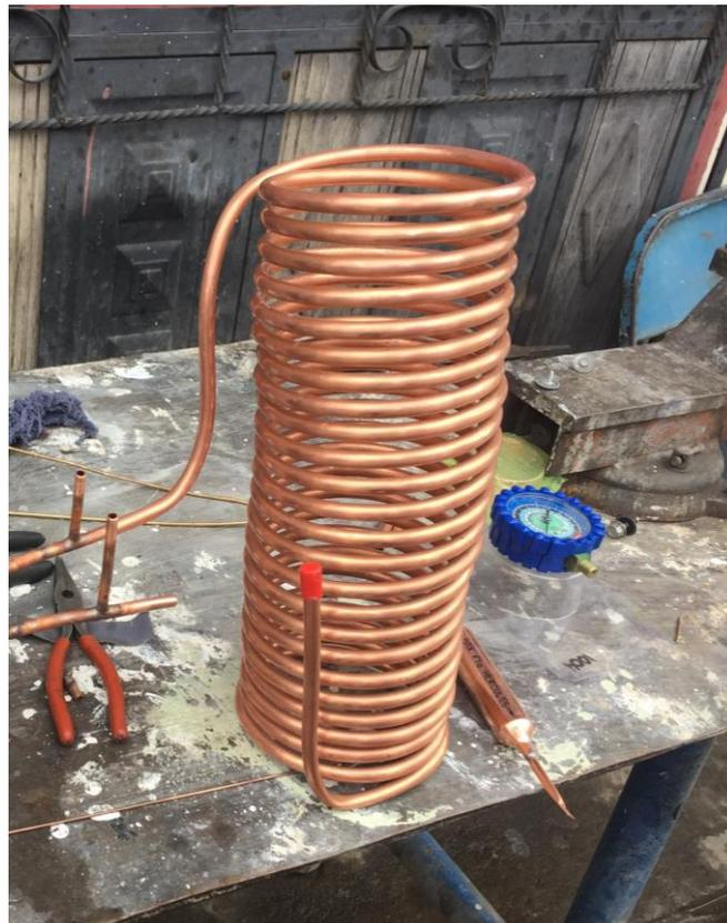
**Figura 8. Evaporador Construido**
