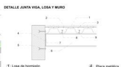
DETALLE JUNTA VIGA, LOSA Y MURO
