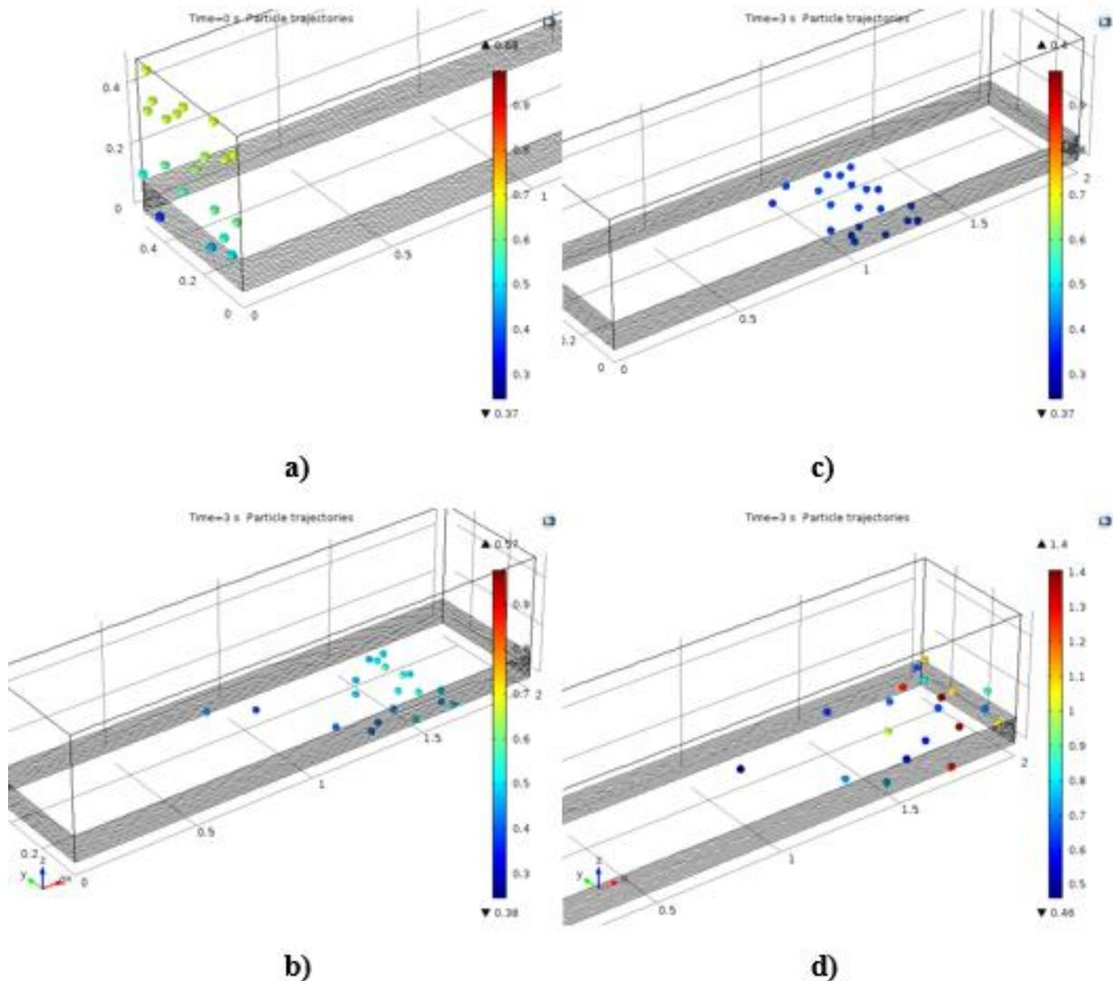
**Figura 7. a) Posición inicial de partículas, b) Posición después de 3 (s), partículas de 100  $\mu\text{m}$  de diámetro, c) Posición después de 3 (s), partículas de 250  $\mu\text{m}$  de diámetro, d) Posición después de 3 (s), partículas de 500  $\mu\text{m}$  de diámetro.**
