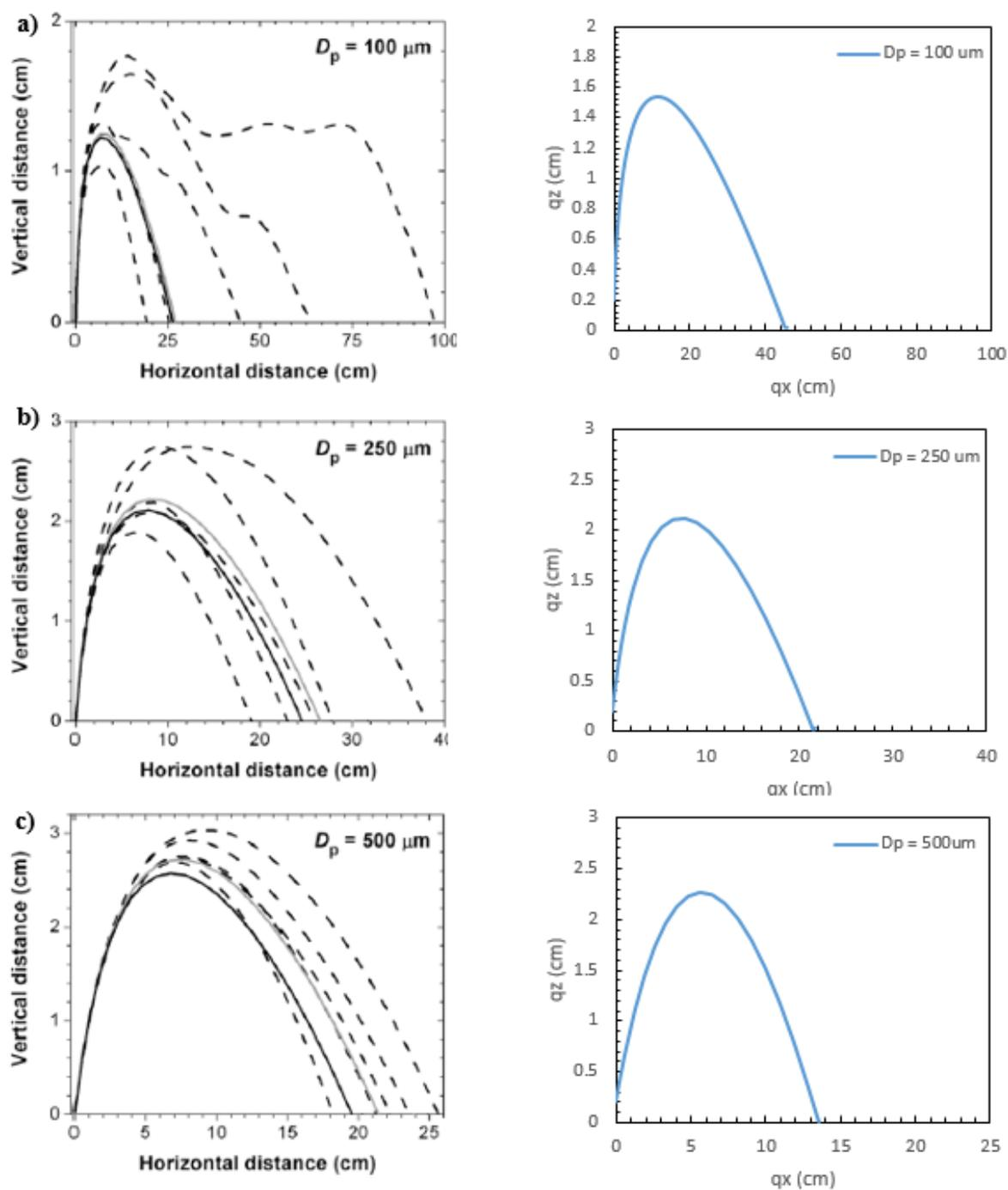
Figura 10. Trayectoria de partículas con diámetros de (a)  $100 \mu\text{m}$ , (b)  $250 \mu\text{m}$  y (c)  $500 \mu\text{m}$ . Las figuras de la derecha representan los resultados obtenidos en esta investigación. Las figuras de la izquierda fueron reproducidas con el permiso del autor, Jasper Kok [4].
