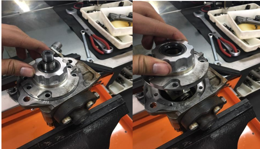
Ilustración 37. Extracción de la tapa del eje principal
