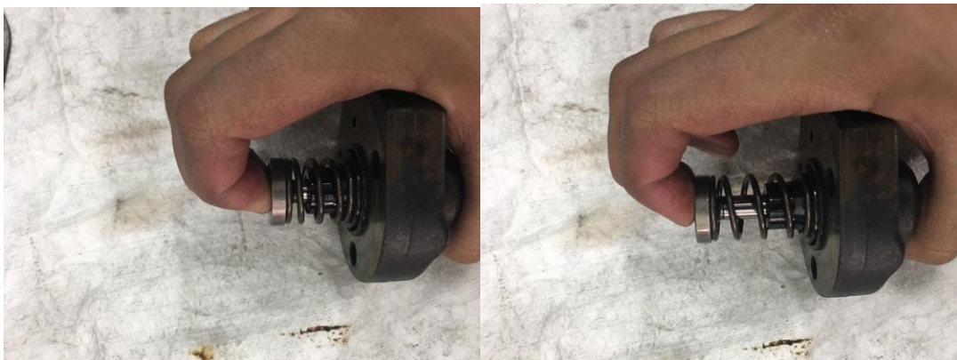
Ilustración 43. Comprobación del elemento en el subconjunto
