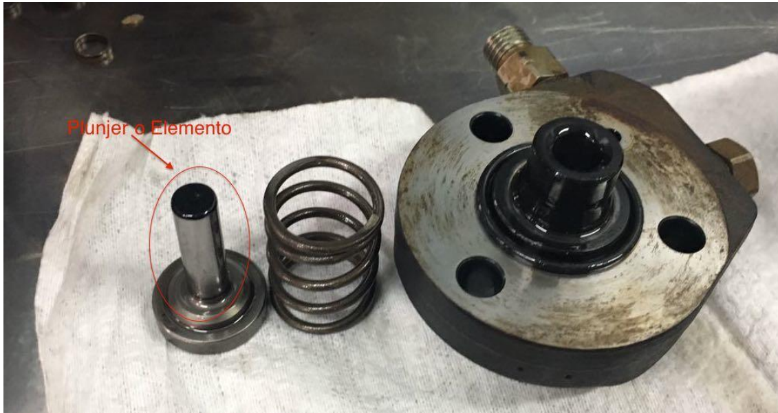
Ilustración 42. Despiece del subconjunto, elemento, resorte y émbolo.
