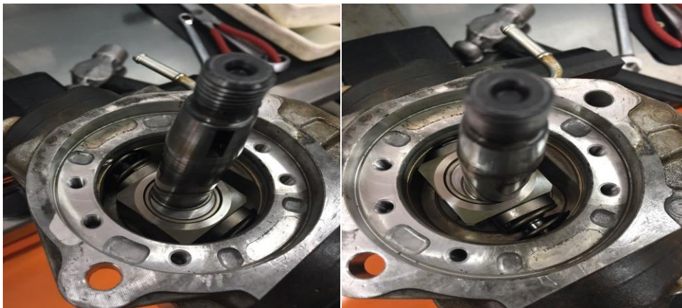
Ilustración 38. Vista superior del eje principal de la bomba.
