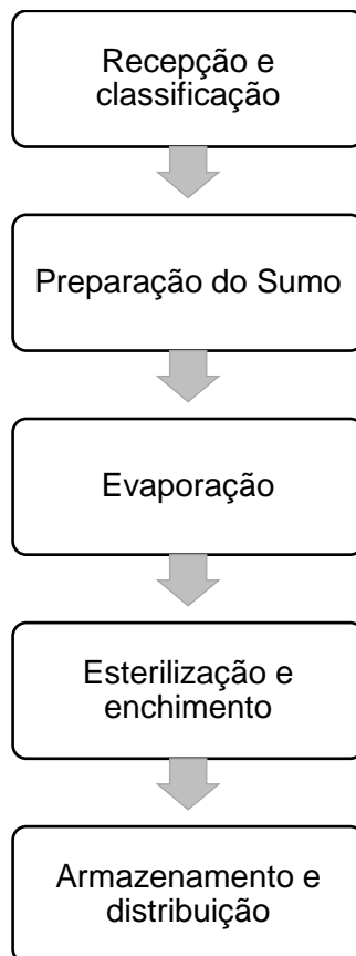
Figura 8. Diagrama de produção de concentrado de tomate
