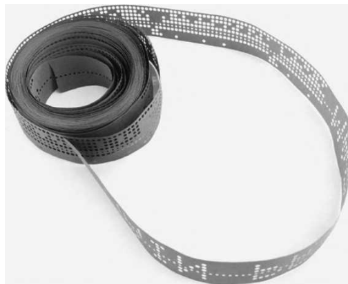
Figura 11 - Fita de papel perfurada que servia para transmitir comandos a computadores não interativos, como no caso da linguagem APT desenvolvida por Douglas Ross (Llach, 2015a)
