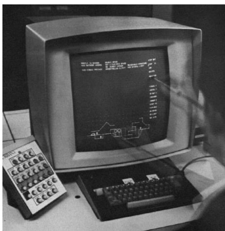
Figura 16 - O URBAN5 com teclado e consola (Negroponte, 1970)
