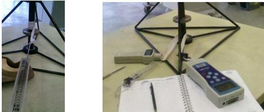
Figura 35 Montaje Para Frenado y Torque Útil
