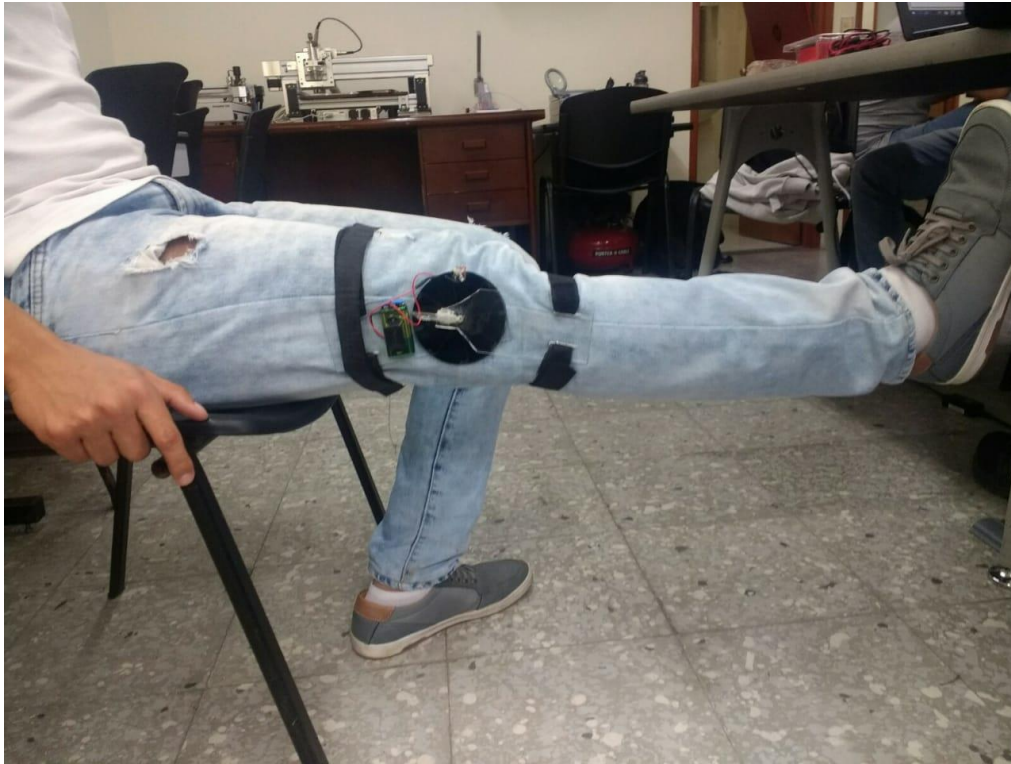
Figura 14. Equipo de limitación de ángulo sujeto en pierna de colaborador.
