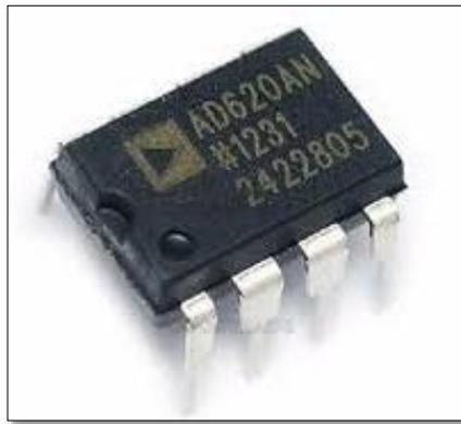
Figura 4. Amplificador de Instrumentación.
