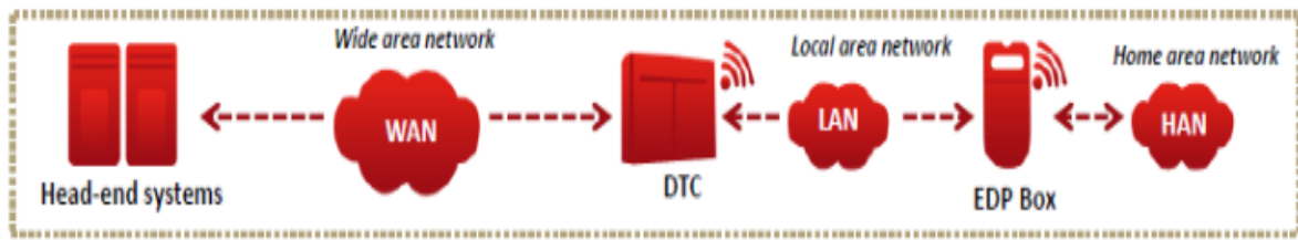
Figura 2.11 - Diagrama da EDP Inovgrid sobre o funcionamento pretendido da rede energética inteligente com smart-meters [28]
