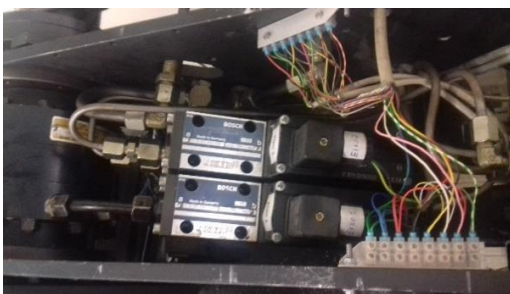
Figura 2.3 – Válvulas proporcionais c/ feedback .
