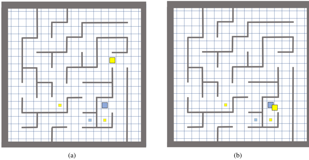
Figura 5.44: (a) Camada temporal 24. Robô azul atinge a célula objetivo da sua última submissão. (b) Camada temporal 32. Se robô amarelo mantivesse a prioridade superior, colidiria com o robô azul.
