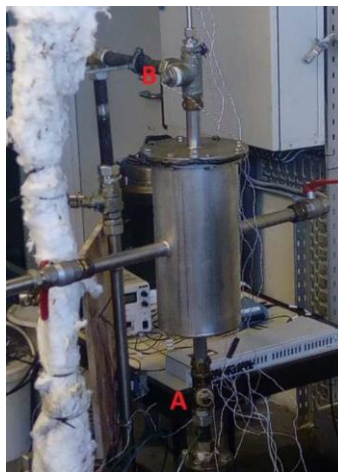
Figura 5.4: Permutador de testes e tomadas de temperatura: (A) entrada do permutador; (B) saída do permutador (Trindade, 2018).
