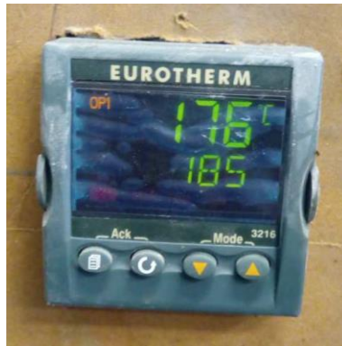
Figura 3.2: Controlador de temperatura do tipo liga/desliga (Trindade, 2018).
