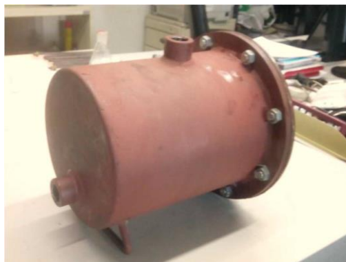
Figura 3.1: Aquecedor utilizado na instalação experimental (Trindade, 2018).
