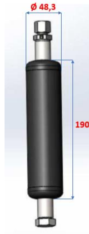
Figura 5.1: Representação da cápsula com indicação das suas dimensões mais relevantes (adaptado de Trindade (2018)).
