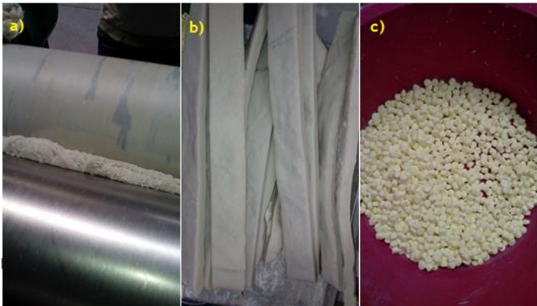
Figura 6 - Incorporação de produto desvulcanizado na borracha virgem nos rolos mecânicos (a), aspeto da borracha virgem (b) e partículas de enxofre (c).
