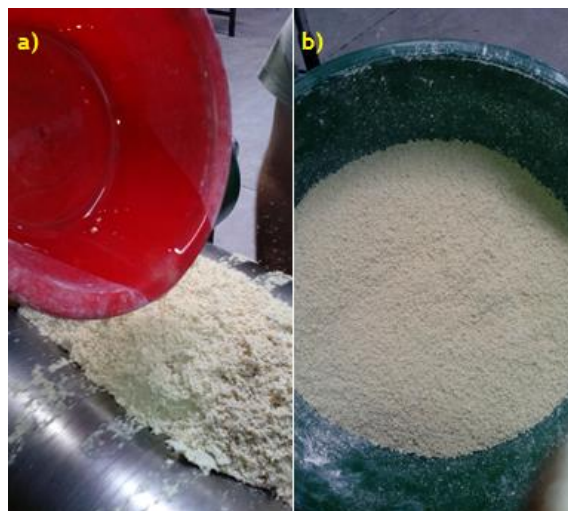
Figura 5 - Adição de óleo de processamento à mistura de borracha moída e agente de desvulcanização nos rolos mecânicos (a) e aspecto de rebarbas de borracha desvulcanizadas (b).
