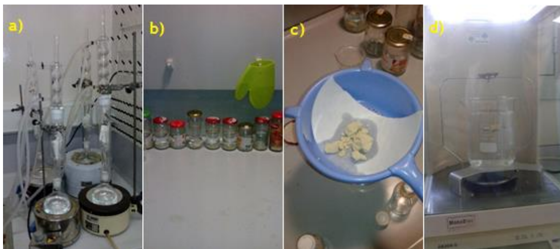
Figura 10 - Extração em soxhlet (a), inchamento em ciclohexano (b), remoção do solvente (c) e medição da densidade da borracha (d).
