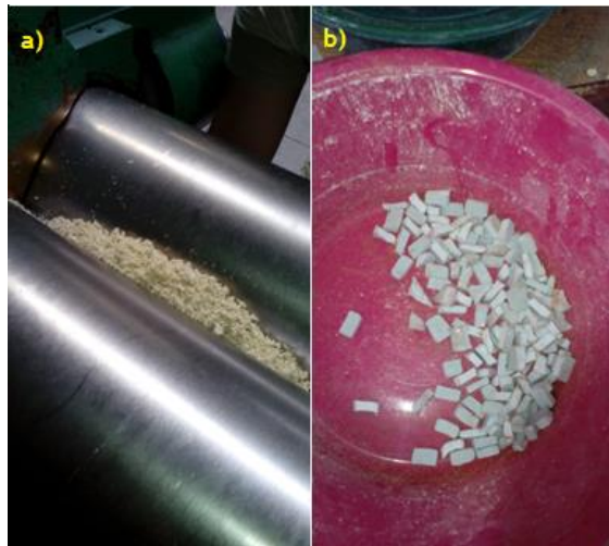
Figura 4 - Rolos mecânicos utilizados para desvulcanização das rebarbas de borracha (a) e aspecto do agente de desvulcanização depois de cortado em pequenos pedaços (b).
