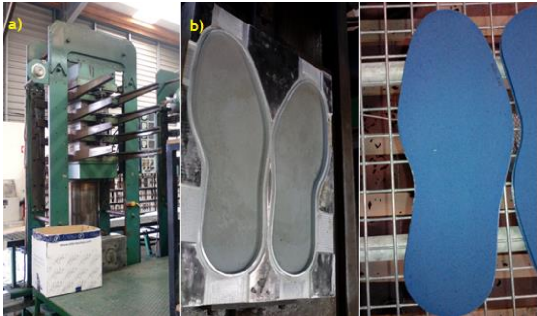
Figura 8 - Fornos (a) e moldes (b) utilizados na empresa Atlanta para a vulcanização de solas de sapatos e aspeto de uma sola vulcanizada a partir de produto desvulcanizado (c).
