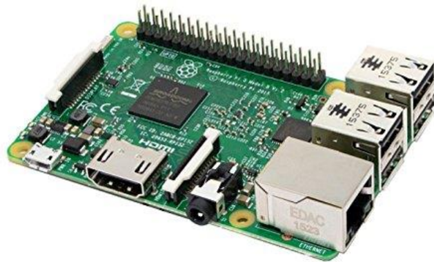
Ilustração 4- Raspberry Pi 3 model B [16]
