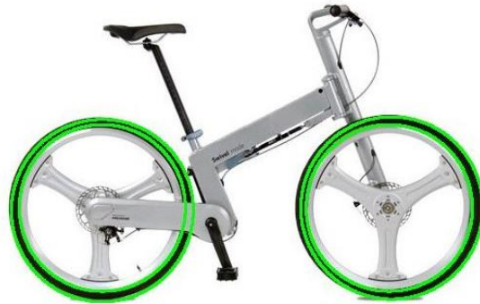
Ilustração 12- Detecção de círculos usando a transformada de Hough [30]
