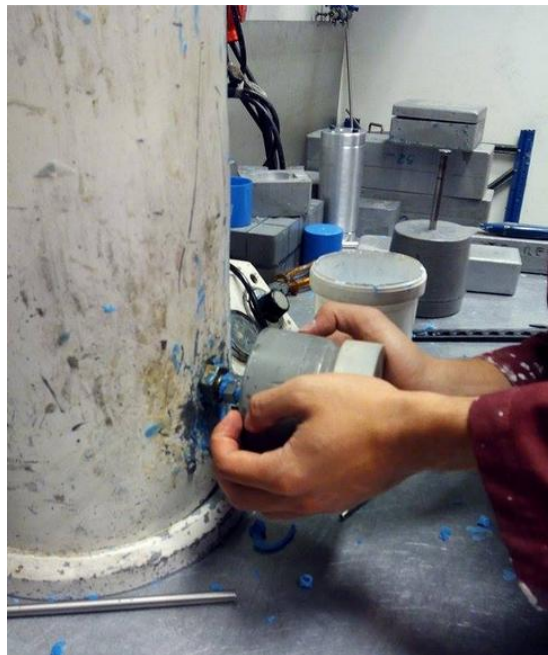
Figura 57 - Fecho do molde e preparação para injeção
