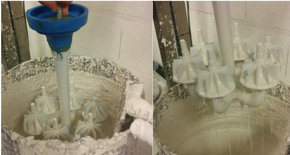
Figura 69 - Mergulho do cacho na barbotina e sua uniformização
