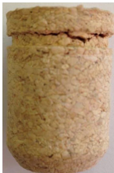
Figura 37 – À esquerda imagem de uma cápsula polimérica sobreinjetada com material a formar o anel do rasgo; à direita a rolha de cortiça com um rasgo após a injeção de material polimérico
