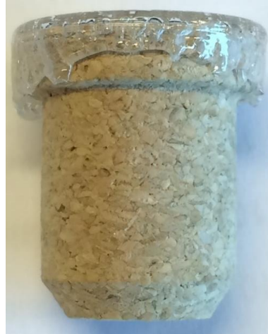
Figura 32 - Cápsula polimérica com déficit de material
