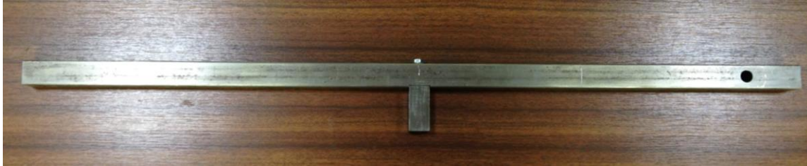
Figura 48 - Barra projetada para a realização da calibração do torciómetro
