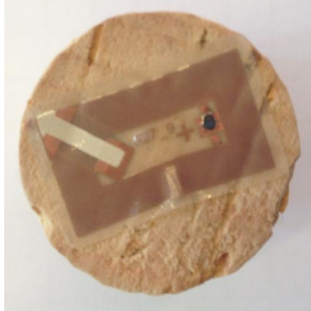
Figura 36 - Rolha de cortiça com a tag colada para posterior sobreinjeção de material polimérico
