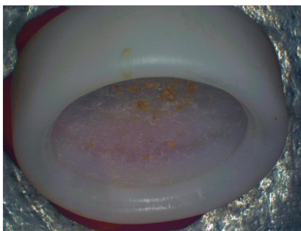
Figura 37 – À esquerda imagem de uma cápsula polimérica sobreinjetada com material a formar o anel do rasgo; à direita a rolha de cortiça com um rasgo após a injeção de material polimérico
