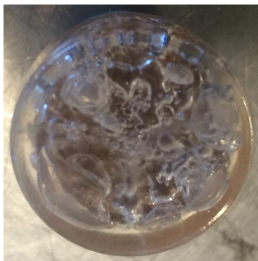
Figura 18 - Cápsula polimérica com bolhas de ar aprisionadas
