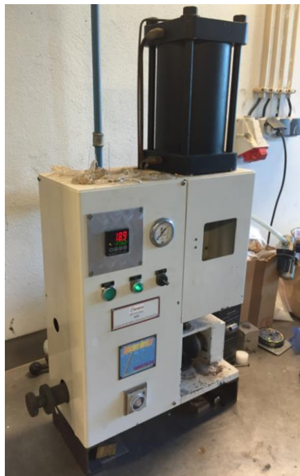
Figura 13 – Máquina injetora com acionamento pneumático utilizada na realização dos ensaios
