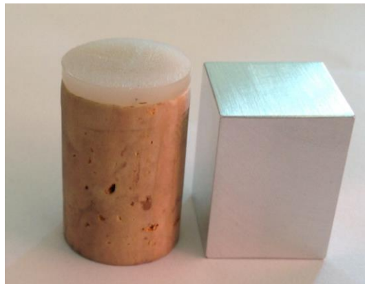
Figura 46 - Rolha de cortiça com disco de material e paralelepípedo de alumínio projetados
