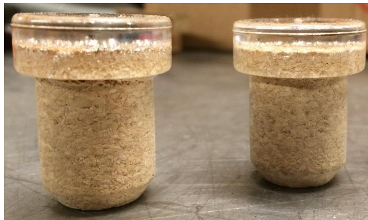
Figura 33 - Cápsulas poliméricas com excesso de material
