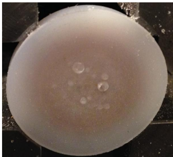
Figura 39 – Bolhas de ar no interior da cápsula polimérica
