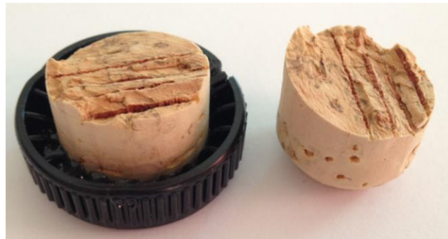
Figura 10 – Rolha de cortiça capsulada produzida pelo processo atual após ensaio mecânico
