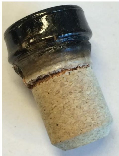
Figura 34 – Rolha de cortiça com aplicação de pressão em excesso
