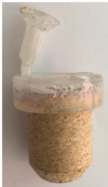
Figura 43 – Rolha de cortiça capsulada com excesso de material no lado onde é feita a injeção de material
