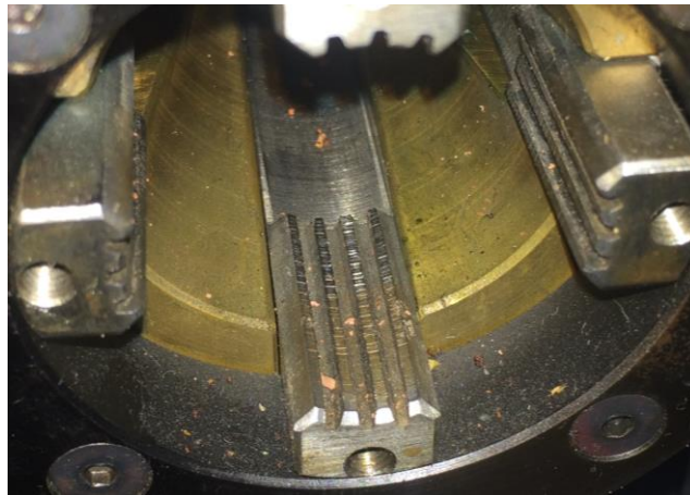
Figura 45 – Mordentes que permitem a realização do aperto na máquina de torção
