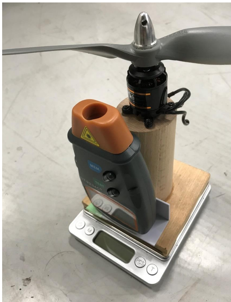
図 2.3 製作した推力測定装置の外観 (11 inch プロペラの場合)
