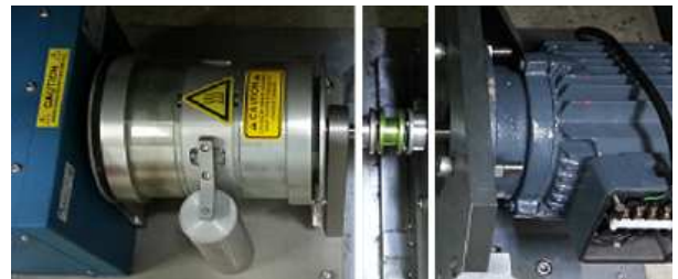
그림 6 2.2kW PMSM 제어 시스템의 장비
