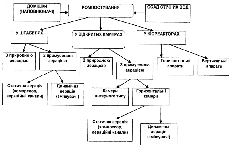
Рис. 6.1. Схема різних методів компостування осадів стічних вод
