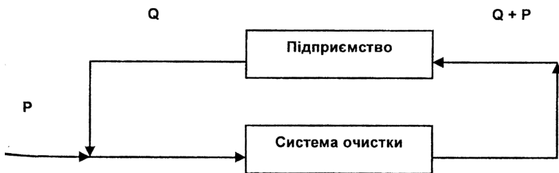
Рис. 6.2. Схема спрощеної безстічної системи промислового водокористування
