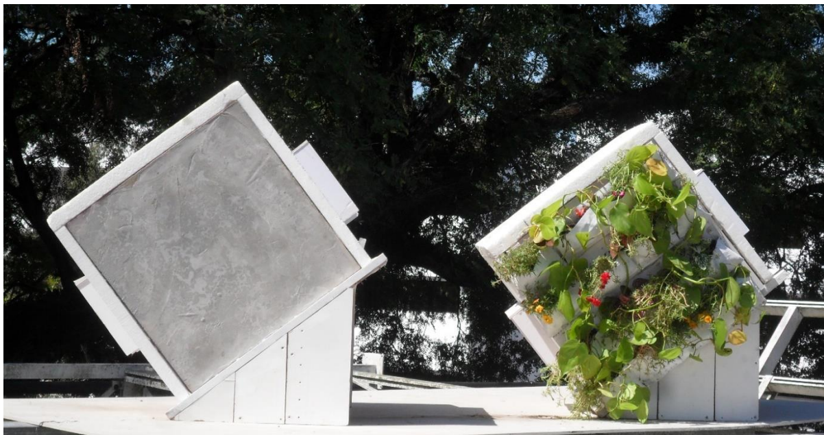
Figura 102. Configuración del aparato experimental para experimentación con la estrategia de muro vegetal. Fuente: Elaboración propia.
