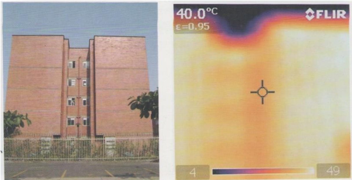
Figura 3. Fotografía vs Termografía de la fachada oeste del conjunto residencial Calicanto en Cali, hora 2pm. Fuente: Gamboa, Rosillo, Herrera, López & Iglesias (2011).
