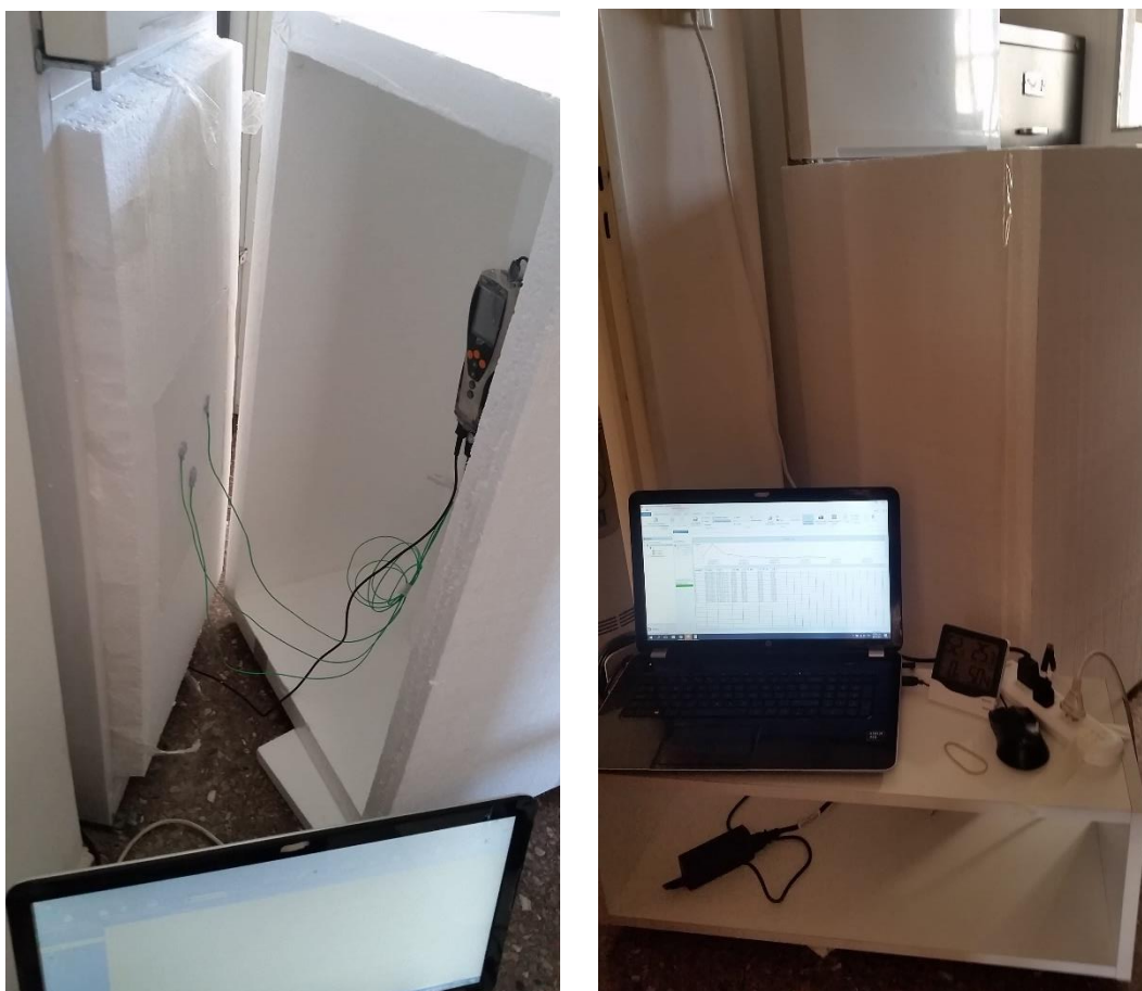
Figura 124. Configuración de la caja caliente calibrada con el panel de AR (Vista interna de la cámara caliente a la izquierda y vista exterior del arreglo cerrado a la derecha). Fuente: Elaboración propia.
