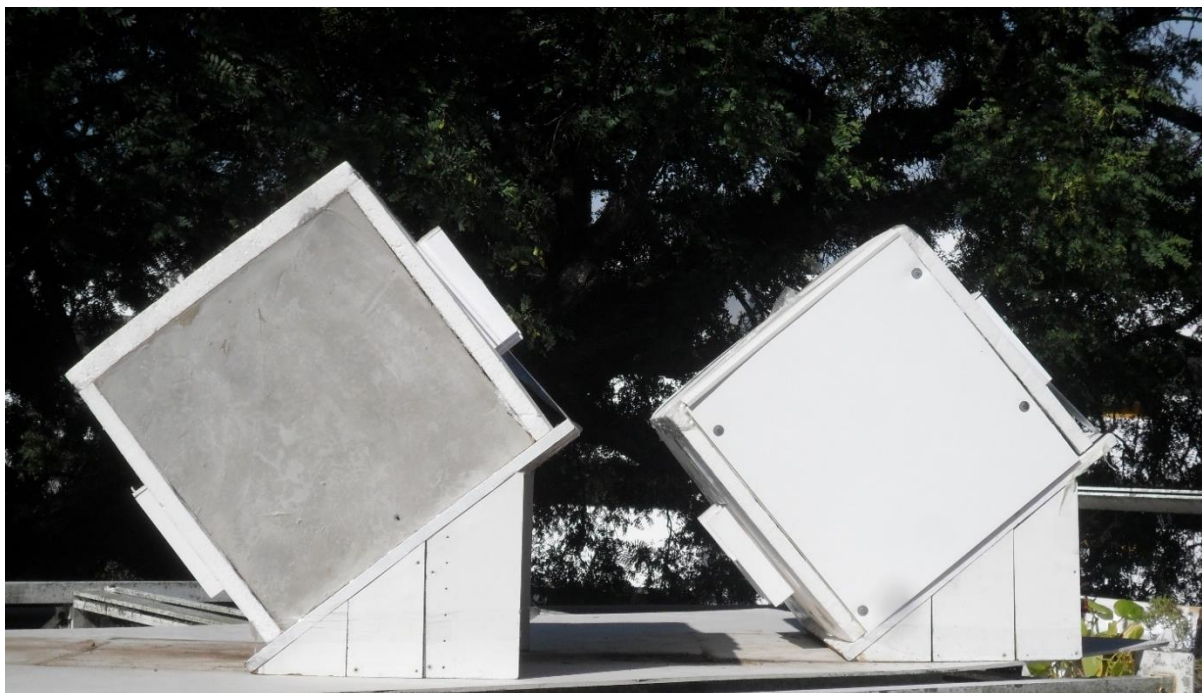
Figura 109. Configuración del aparato experimental para experimentación con la estrategia de aislamiento reflectivo + baja absorptividad. Fuente: Elaboración propia.
