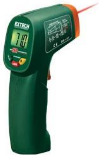
Figura 163. Termómetro infrarrojo marca Extech modelo IR42500. Fuente: Giraldo (2013).
