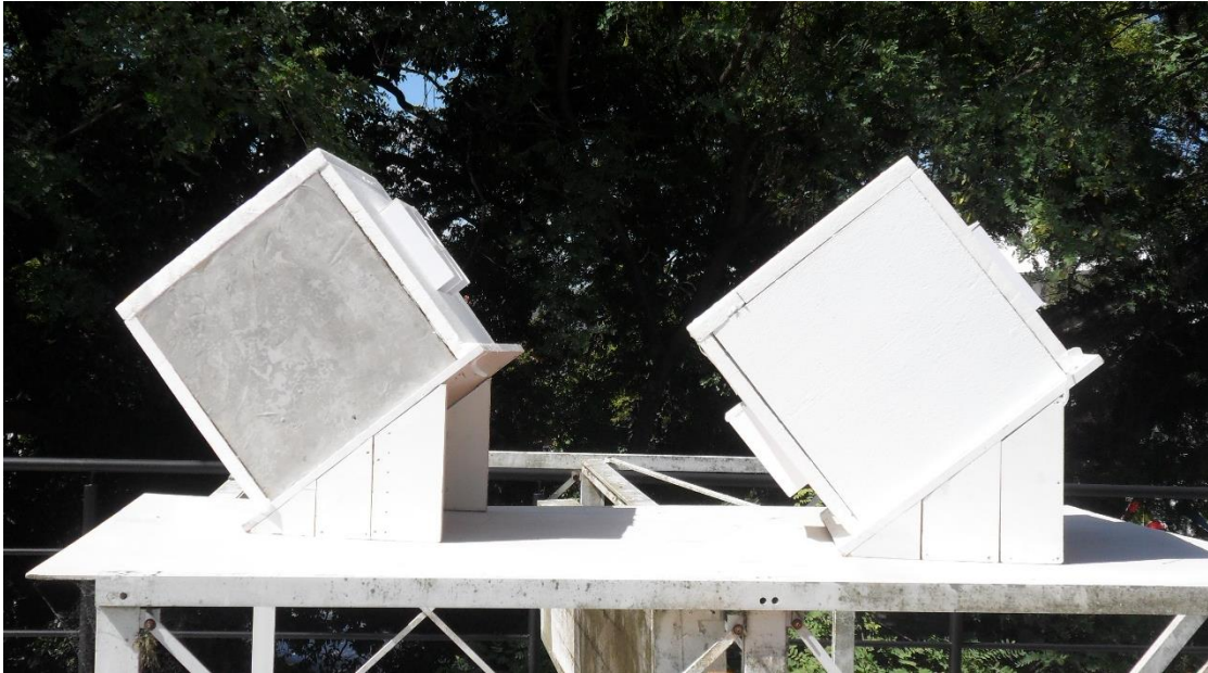
Figura 88. Configuración del aparato experimental con la estrategia de baja absorptividad. Fuente: Elaboración propia.
