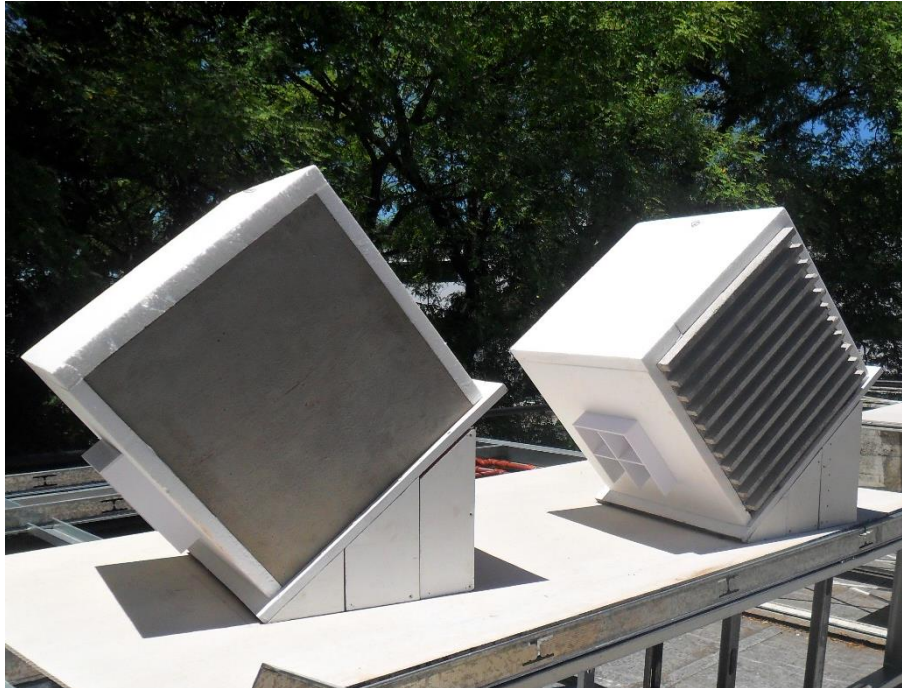
Figura 82. Configuración del aparato experimental para experimentación con la estrategia de autosombreado. Fuente: Elaboración propia.
