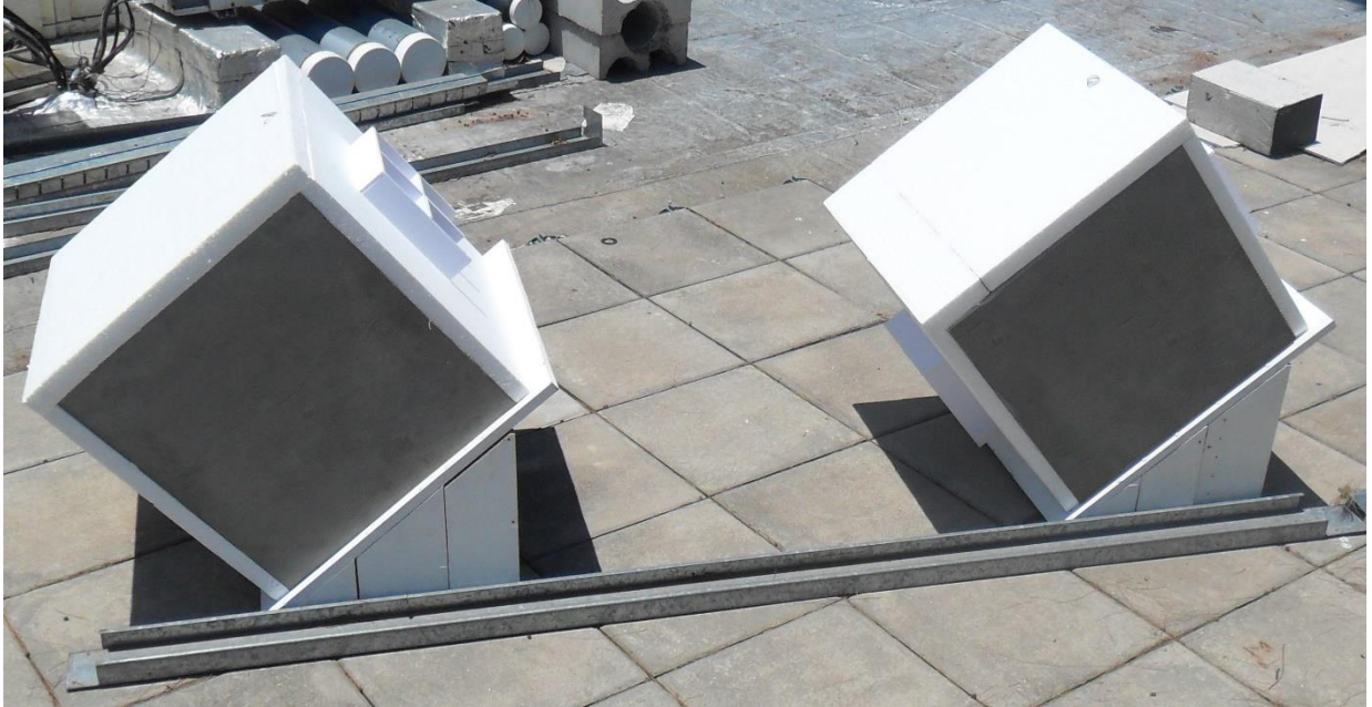
Figura 73. Disposición final del aparato experimental que consta de dos módulos idénticos de poliestireno expandido y concreto sobre una base inclinada 38.35^\circ hacia el norte. Fuente: Elaboración propia.
