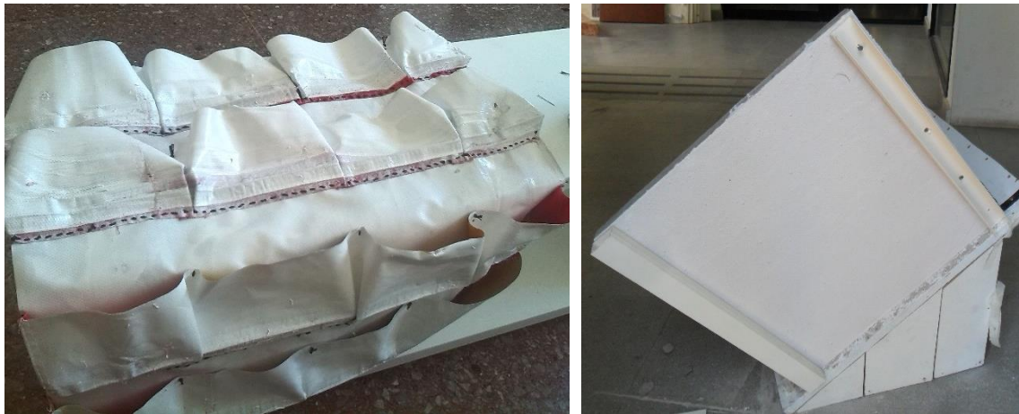
Figura 100. Configuración de la lona antes de recibir el sustrato y las especies vegetales (izquierda) y la estructura de perfiles de PVC (derecha). Fuente: Elaboración propia.
