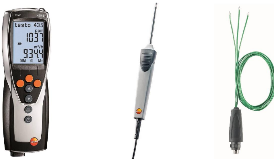
Figura 161. Instrumental de medición para obtener la transmitancia térmica: Izquierda: Registrador y procesador de datos Testo 435-2; Centro: Sonda de T_{air} Testo 06021793 y Derecha: Sensor de T_{air} y T_r Testo 06141635. Fuente: Testo Argentina, https://www.testo.com/es-AR/
