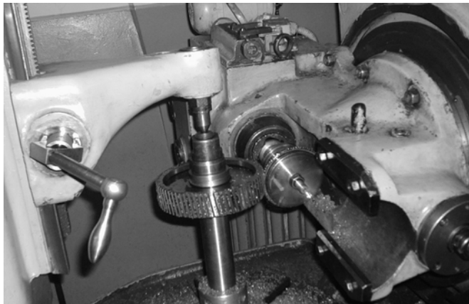
Рисунок 3 – Нарізання синусоїдального зубчастого колеса дисковою фрезою на універсальному зубофрезерному верстаті при неперервному обкочуванні
