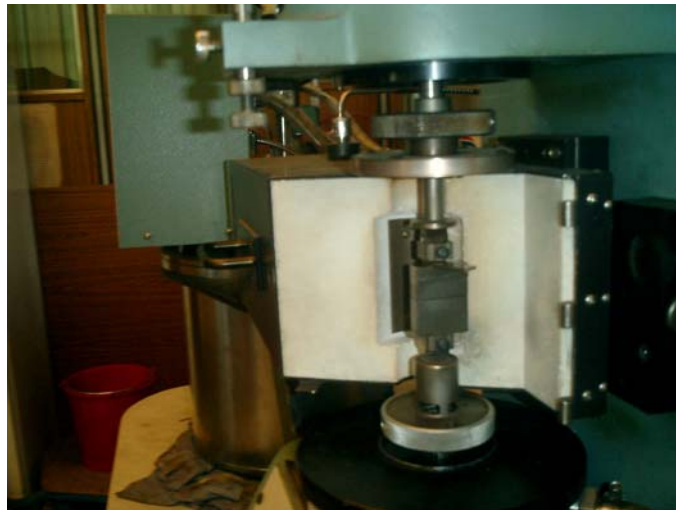
Photo 7 : Pendule de torsion et son enceinte thermique
