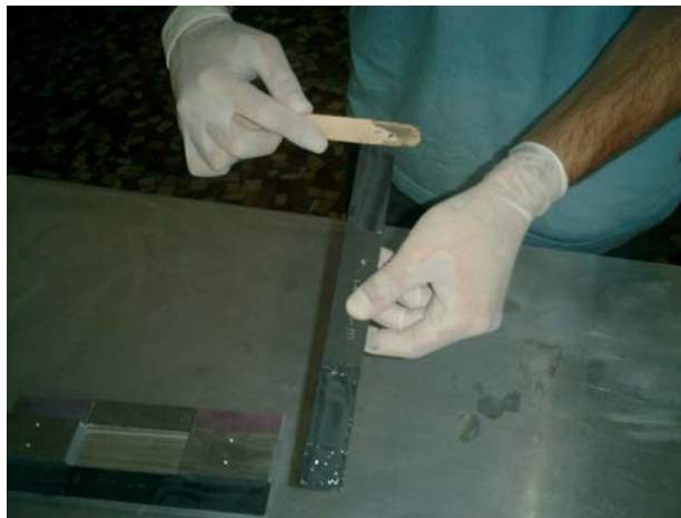
Photo 3 : Collage de talons sur les éprouvettes
