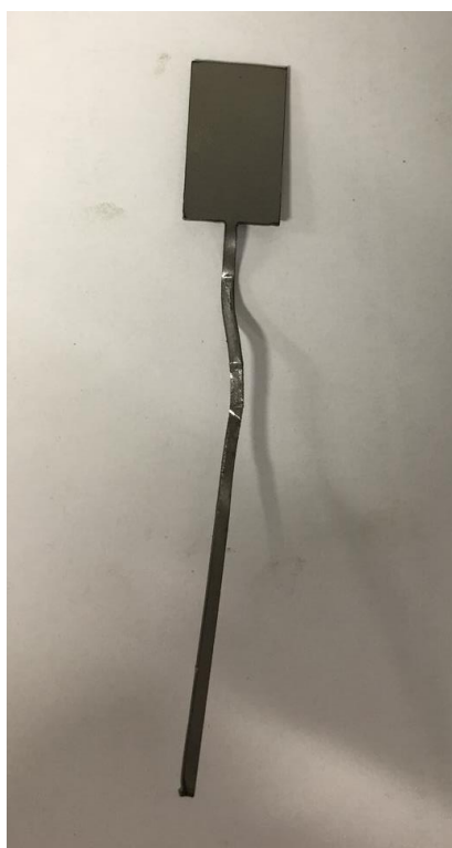
Figura 48: Foto fusible deformat
