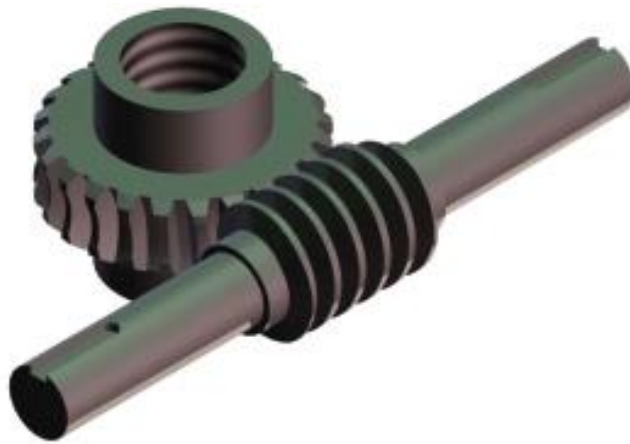
Figura 44: Mecanisme intern del gat amb cargol de potencia
