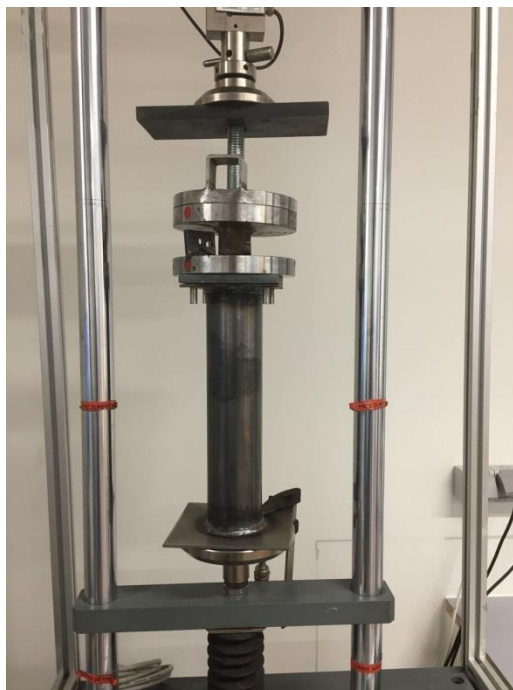
Figura 26: Muntatge del segon utillatge amb serjant
