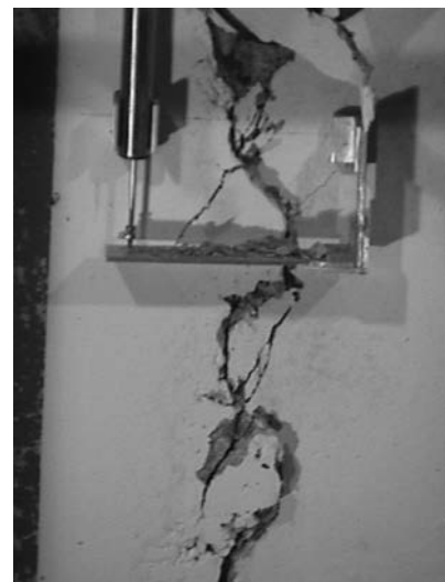
Figura 10. PC-JC. Estado en el que se encontraban las llaves en la fase de prerrotura.
