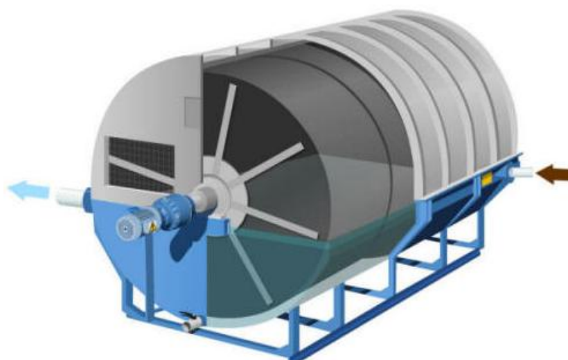
Figura 22. Representación de Biorreactor de disco rotatorio. Fuente: Reactors (2013)
