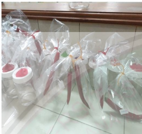
a. Cabai didiamkan selama 6 jam dan diberikan selang yang terhubung langsung dengan NaOH
