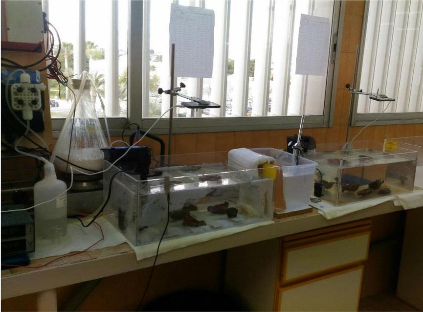
*Figura 1: Disposición de los tanques en el laboratorio. De izquierda a derecha, el regulador de pH, el tanque experimental, el tanque anolito y el tanque control. Ambos tanques, experimental y blanco, tienen sobre ellos soportes con móviles para las fotografías.*
