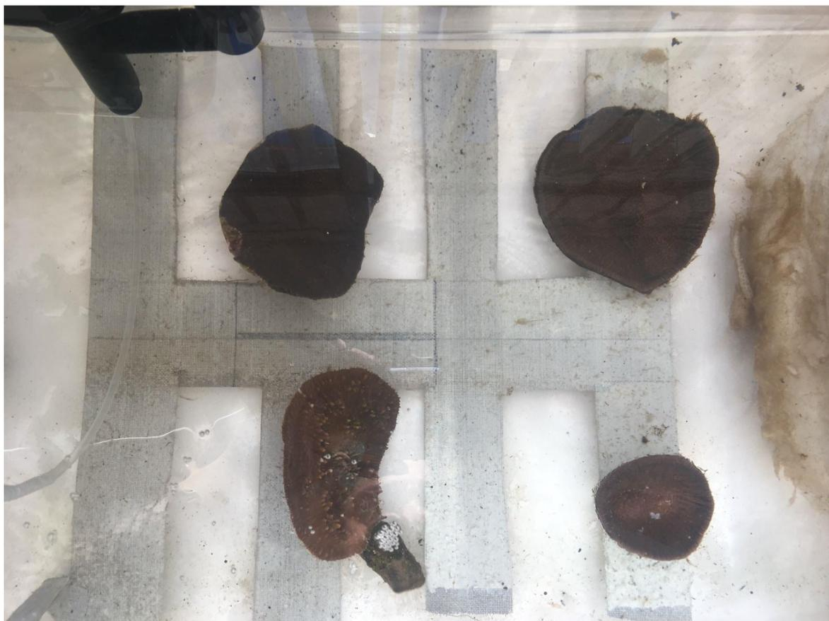
*Figura 2: Rejilla actuando de cátodo en el tanque de electrolisis.*
