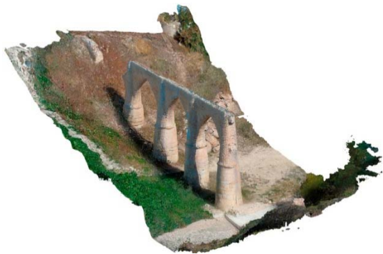
Figura 5. Ejemplo de nube de puntos de acueducto romano elaborado con Photoscan. Alumna Aixa Mireia Molina García. Trabajo final de Grado: Aplicación de la fotogrametría digital para la representación tridimensional del Acueducto de Puça en Petrer (Alicante)
