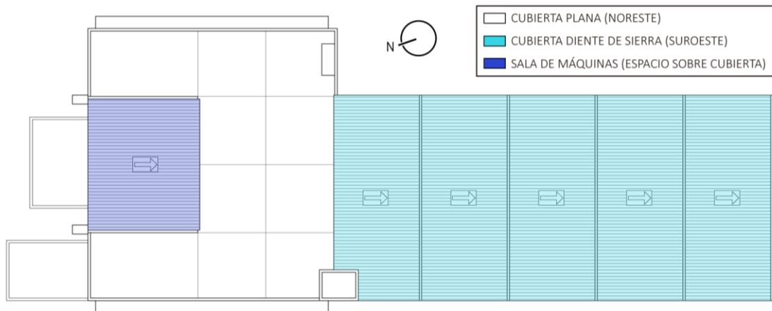
Figura 28. Esquema de los tipos de cubierta de la nave I (Plano de planta cubierta). Fuente: elaboración propia.
