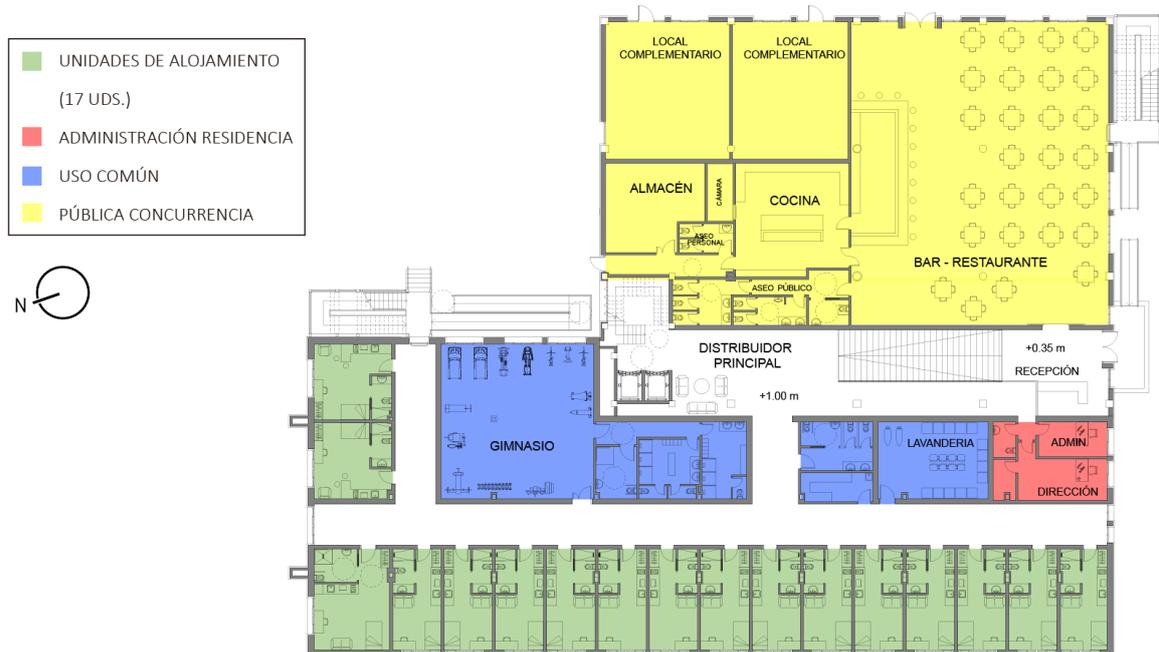
Figura 93. Esquema de planta baja con la división de usos principales. Fuente: elaboración propia
