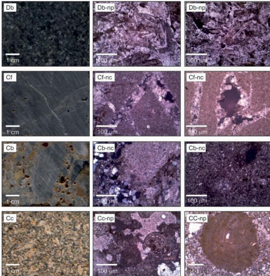
Fig. 2.- Aspecto de las rocas estudiadas en muestra de mano (columna de la izquierda) y en microscopio petrográfico. Db: diabasa; Cf: caliza fracturada; Cb: caliza brechoide; Cc: calcarenita; np: fotomicrografía adquirida con nicoles paralelos; nc: fotomicrografía adquirida con nicoles cruzados. Ver figura en color en la web.
